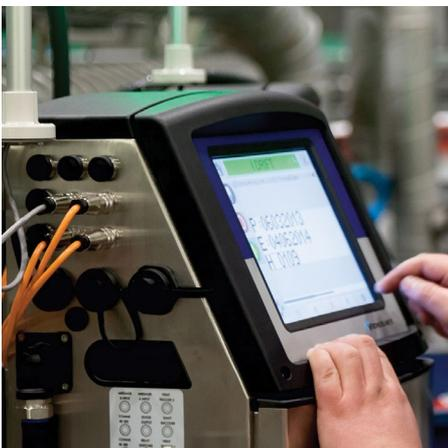
**Como sugestão, os IP65 conectores Ethernet nas nossas impressoras oferecem uma conexão mais resiliente e durável e podem ser usados em ambientes que não sejam de IP65.**
